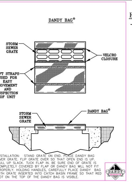
**DETAIL OF INLET SEDIMENT CONTROL DEVICE**
