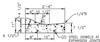
STANDARD ROLL TYPE CURB & GUTTER
