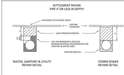
**ITEM SPECIAL - LOW STRENGTH MORTAR BACKFILL MATERIAL**
